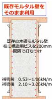
図6 モルタル壁の補強
