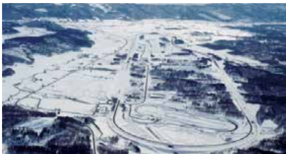
↑930haの広さ(新千歳空港の約1.2倍)のトヨタ自動車士別試験場。約4kmのストレートや43度のバンクなどを有する。
