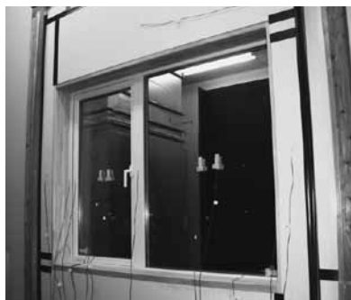
写真1. 断熱性能測定の様子
